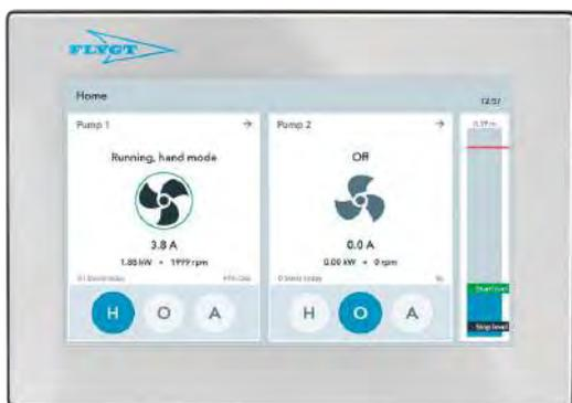
*Вариант 1: Интуитивно понятный HMI-дисплей для легкой навигации. Имеется мастер настройки, помогающий пользователю осуществить весь процесс ввода системы в эксплуатацию*
